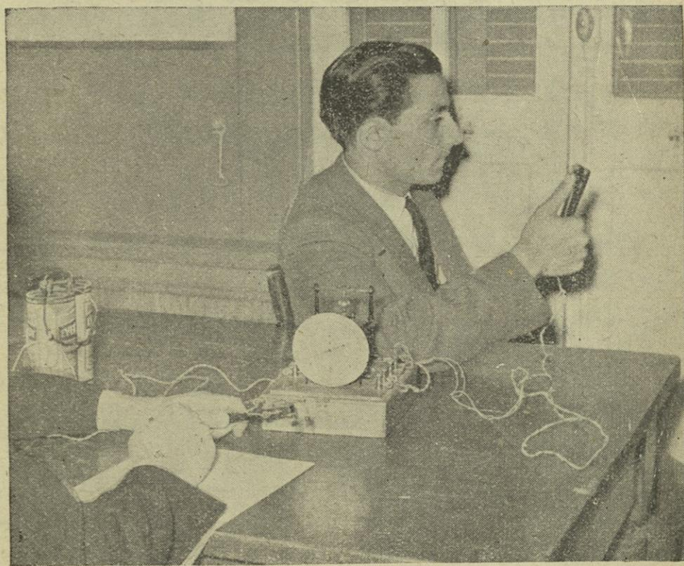
شكل ٣ - جهاز الكرونسكوب أو «الم zaman» لتسجيل زمن الرجع
