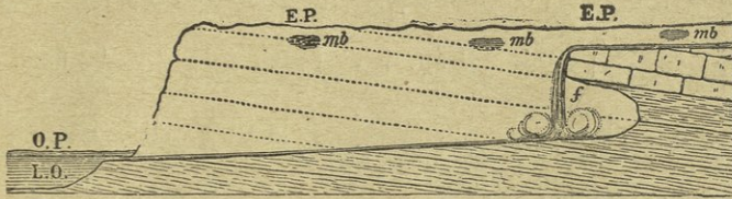
صورة تمثل كيف حفرت مساقط نياجرا
