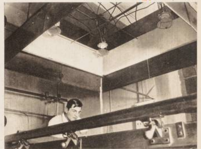
الطبع على الورق الحساس : إحدى عمليات الطباعة بالروتوغرافور
