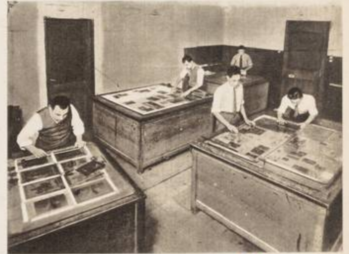
« المونتاج » ترتيب الصحائف على البلور قبل طبعها على الورق الحساس
