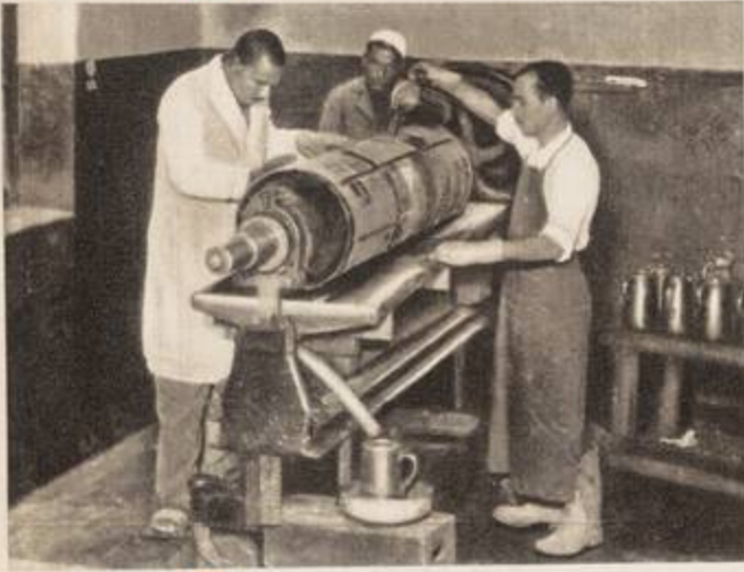
قسم الحفر : وترى إحدى الاسطوانات النحاسية أثناء حفرها
